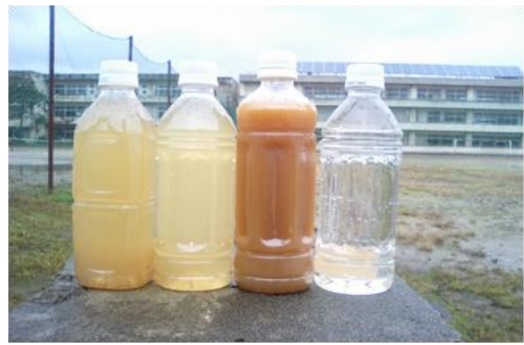
図-12 揚水試験中の地下水
