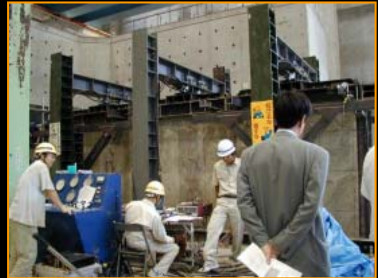
実規模気泡モルタル盛土の水平載荷試験 （JR東日本(株)本社構造技術センター委託）
