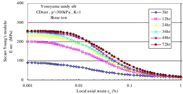
Fig.7 ヤング率 - 局所軸ひずみ関係
