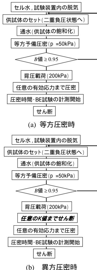
Fig.2 試験フロー
