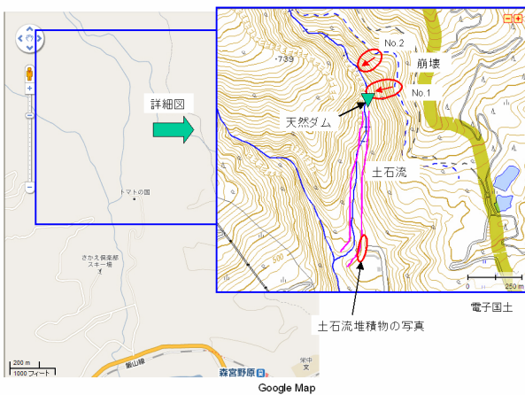
図2.6-1 栄村北信の斜面崩壊箇所
