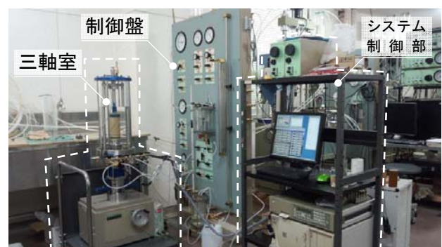
図 1 三軸試験装置の構成（レストアした実物）
