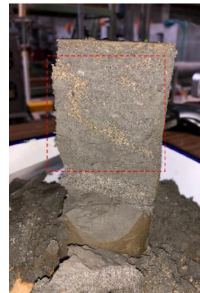
Fig. 33 T1-2 (No. 2) 試料における液状化痕傾向が確認された。
