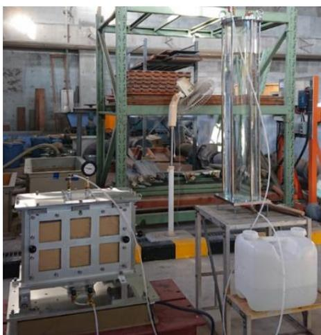
図-1 模型振動台及び槽
