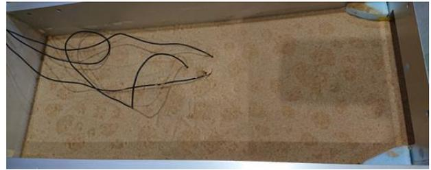
図-15 液状化後の供試体表面
