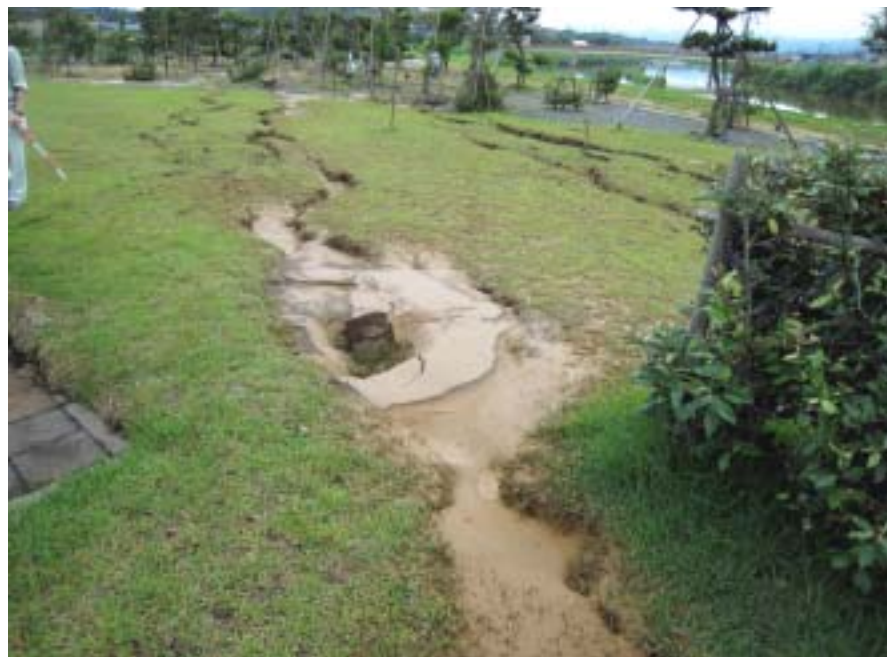
噴砂を伴いながら、河川方向に側方流動
