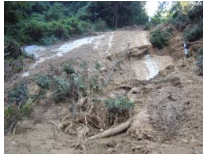
泥岩の流れ盤(約32度)
