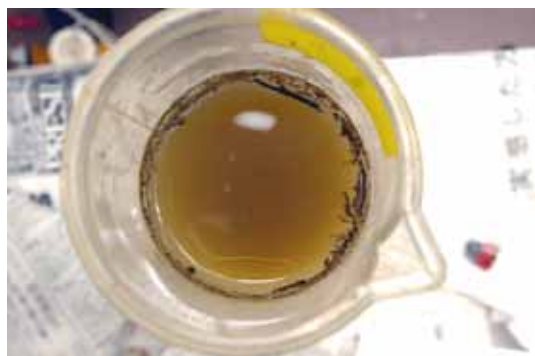
口絵 5-17 植物の根などを含む猿橋川堤体土
