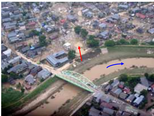
口絵 5-11 中之島における刈谷田川の破堤 (提供：国土交通省北陸地方整備局)
