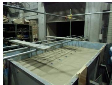
Fig 5 実験土槽の外観
