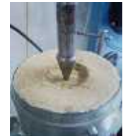
Fig.7.3 コーン貫入状況
