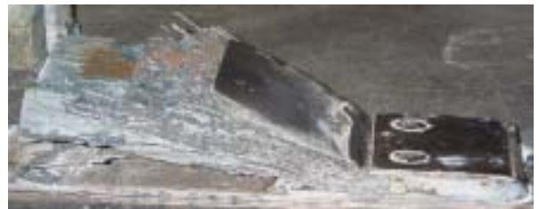
図 3 裏込めが固化したワイヤーブラシ
