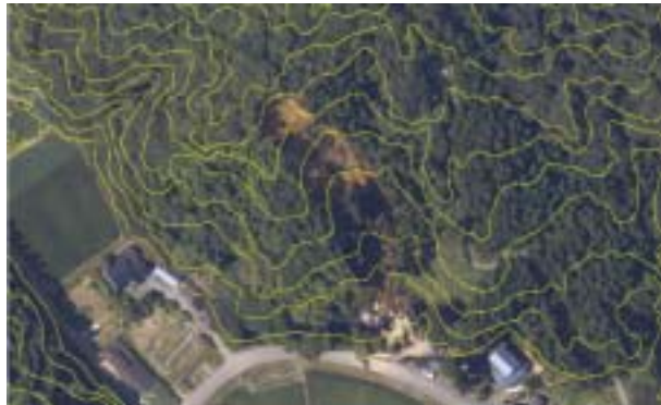
図 11 中山の斜面崩壊の等高線 (朝日航洋(株)提供)
